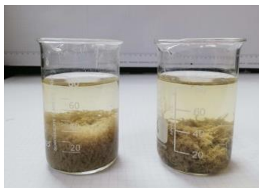
Фигура 1.8-3 Резултати от обработката на оборотната технологична вода с различни реагенти
